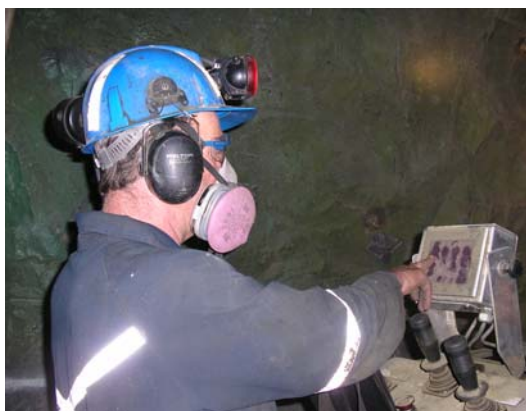
Bild 2: Operatörspanel varifrån operatören kan ändra vissa inställningar för den automatiska styrningen samt även styra bomrörelsen manuellt.
